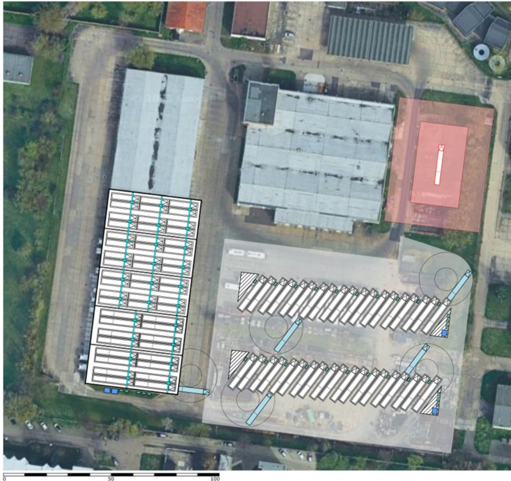
Abb. 69: Betriebshofintegration (BEV) mit Neubau Abstellhalle und Schrägaufstellung im Freibereich
