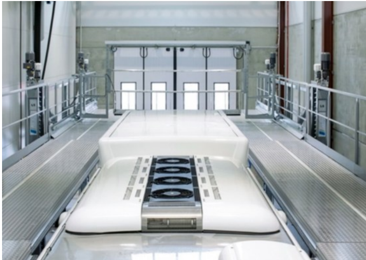
Abb. 73: Dacharbeitsstand (Blick von oberer Ebene auf Fahrzeugdach)
