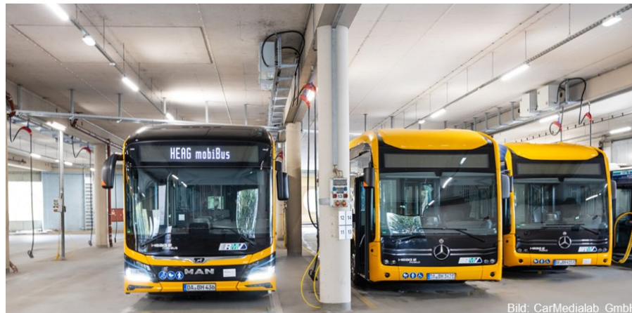
Abb. 62: Praxisbeispiel Depotladung mit Steckerzuführung von oben
